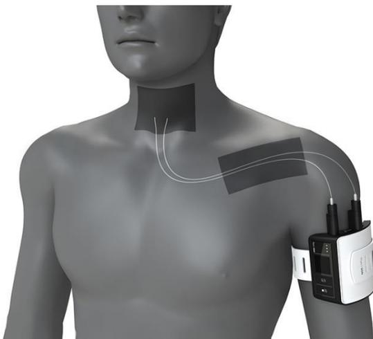
Bildunterschrift: Simulation des Nachblutungsdetektors ISAR-M THYRO® von ISAR-M an einem Dummy.
